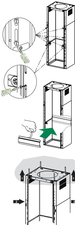
Antes de apertar os parafusos definitivamente, é possível fazer ajustes, rodando a armação e prestando atenção aos parafusos, que não podem sair da sede do orifício oval de ajustamento.
