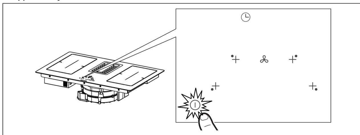
Tryck på PÅ/AV-knappen ① i 2 sekunder för att slå på och aktivera spishällens funktioner. Samtliga teckenrutor visar 8. och de för timern "C L".
