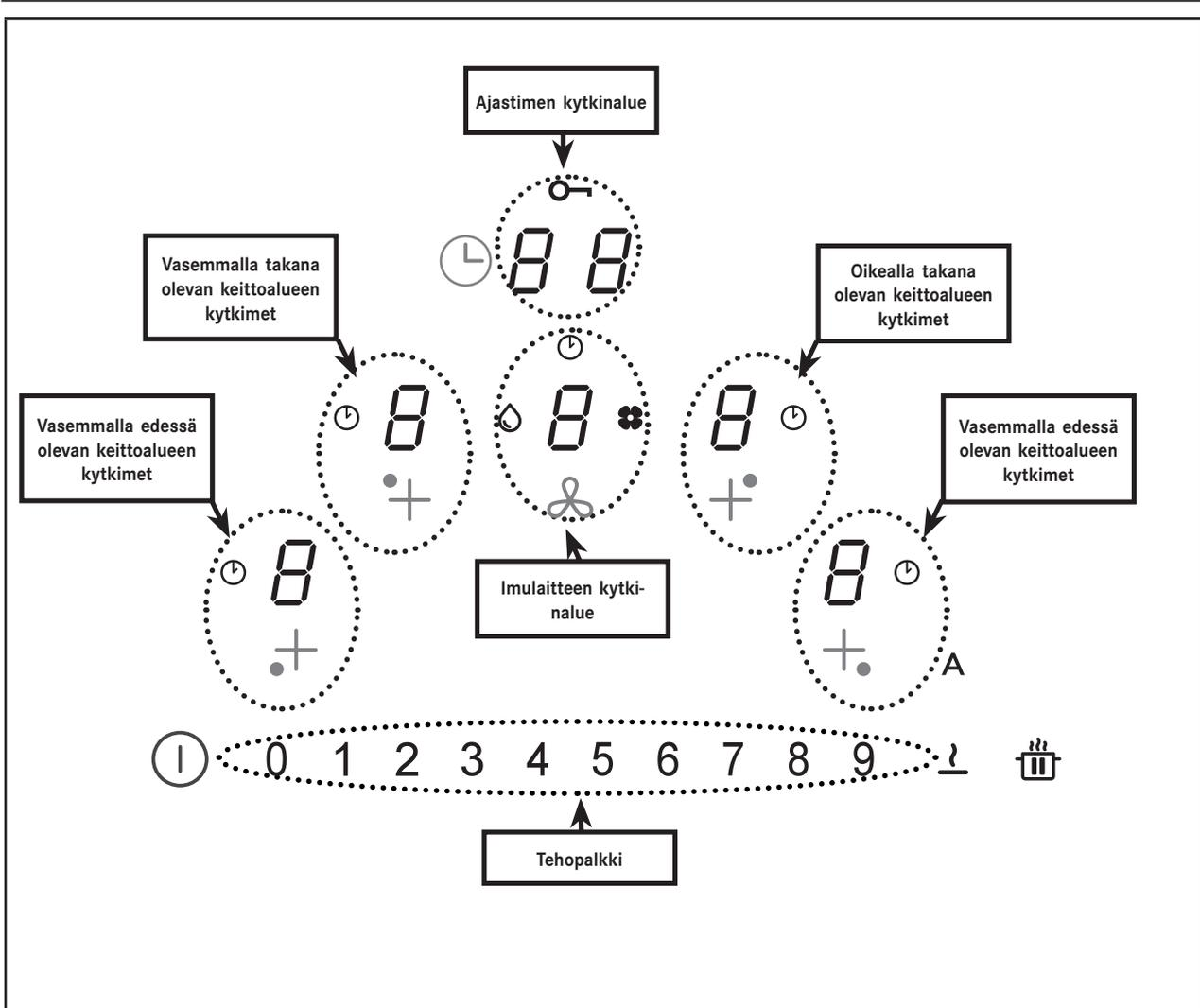
Keittoalueiden, imulaitteen ja ajastimen kytkinalueet voidaan aktivoida painamalla viitettä
