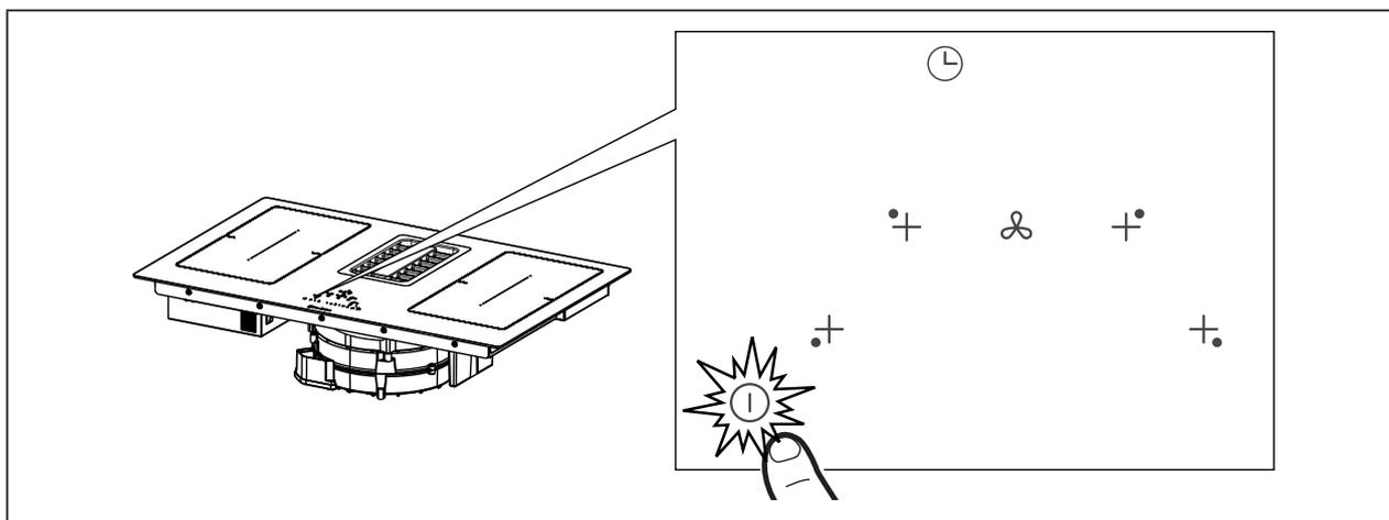
Trykk på på/av-knappen ① i 2 sekunder for å slå på platetoppen og aktivere platetoppens funksjoner. Alle nummervisningene viser 0, og de til timeren viser " C L ".
