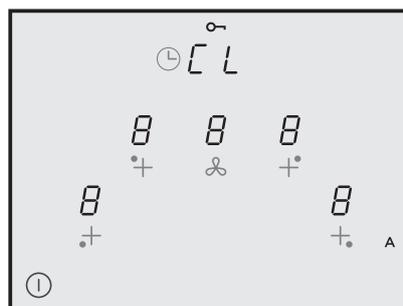
Neste momento, a placa está ligada mas todas as zonas de cozedura e o exaustor estão a zero de potência. A Placa desliga-se automaticamente ao fim de 20 segundos, se não for utilizada.
