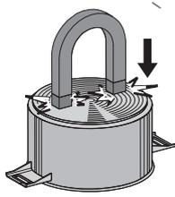
**Huomio:** Käytä vain kattiloita, joiden pohja on täysin tasainen ja sopiva induktiokeittoalueelle. Sellaisten kattiloiden käyttäminen, joiden pohja ei ole tasainen, voi haitata lämmönsäätelyjärjestelmää ja estää kattilan tunnistamisen keittoalueella.
