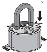
**Atenção:** utilize exclusivamente tachos com fundo perfeitamente plano e adequado para zonas de cozedura por indução. A utilização de tachos com fundo irregular pode prejudicar a eficiência do sistema de radiação de calor e entravar a deteção de presença de tacho na zona de cozedura.
