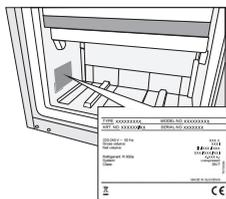
La placa de características se puede encontrar en el interior del electrodoméstico. Contiene informaciones sobre la tensión, el volumen bruto y neto, el tipo y la cantidad de refrigerante y la información sobre las clases de clima.
