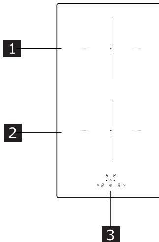
1 | Pojedinačna zona za kuhanje (160 mm) 1400 W, S funkcijom Booster od 2100 W.
