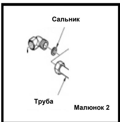
Для надійного під'єднання газової труbi використовуйте сальник, який входить в комплект поставки. Необхідно дотримуватися застосовних правил щодо встановлення газового обладнання. Після з'єднання перевірте відсутність витоків за допомогою мильної води.
