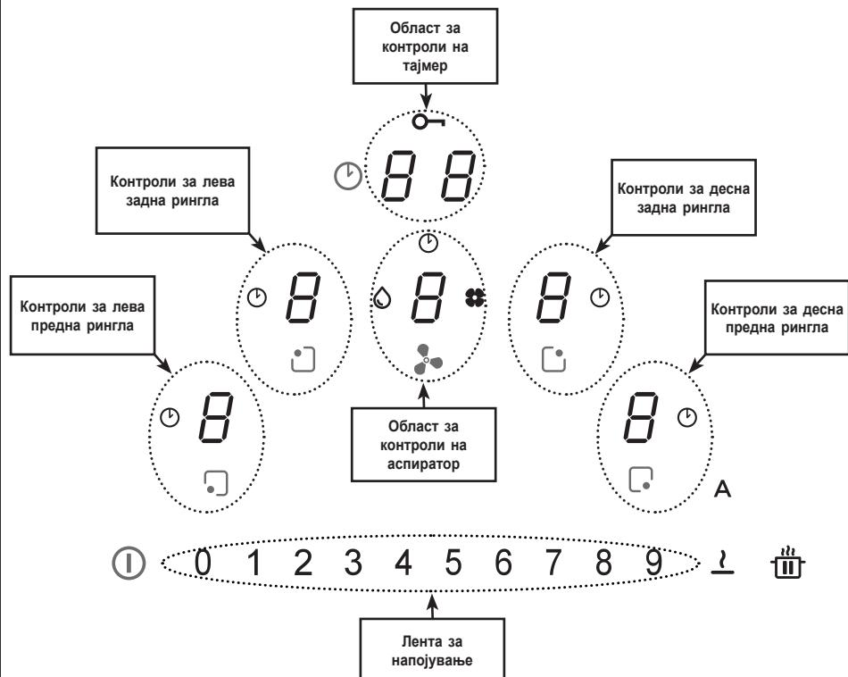
Контролите за ринглите, аспираторот и таймерот може да се активираат со притискање на соодветниот сензор **B**.
