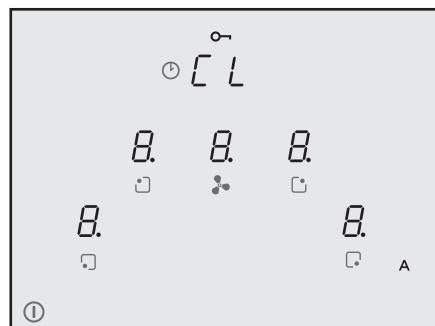
Осы сәтте плита қосылған, бірақ барлық өзірлеу аймағы мен сорғыш нөлдік қуатта. Плита 20 секунд пайдаланылмаған жағдайда автоматты түрде өshedі.
