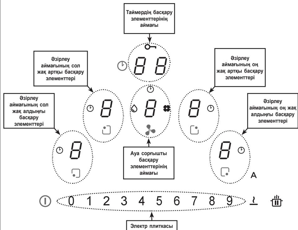
Өзірлеу аймақтары, ая сорғыш және таймерге арналған басқару элементтерін реттеу цифр белгісін **8** басу арқылы іске қосуға болады.
