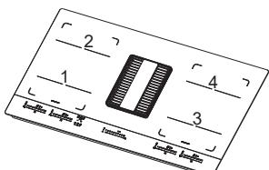
1,2 Pole grzejne 1+2; Połączone
