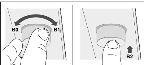
Tourner le bouton dans le sens des aiguilles d'une montre pour augmenter les vitesses en passant de:
