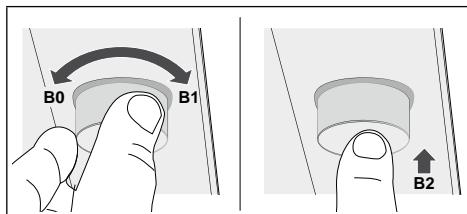
Durch Drehen des Knaufs im Uhrzeigersinn wird die Geschwindigkeit erhöht und wechselt von: OFF-1°-2°-3°- INTENSIVGESCHWINDIGKEIT (**B1**).
