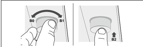
Okretanjem upravljačkog gumba u smjeru kazaljke na satu, povećavaju se brzine prelazeći sa: OFF-1°-2°-3°-INTENZIVNA (**B1**).
