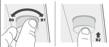
Otáčením knoflíku po směru hodinových ručiček se rychlosti budou zvyšovat a budou přecházet z: OFF- $1^{\circ}$ - $2^{\circ}$ - $3^{\circ}$ -INTENZIVNÍ (**B1**).
