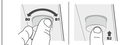
Obrót pokrętła w kierunku zgodnym z ruchem wskazówek zegara powoduje zwiększenie prędkości:
