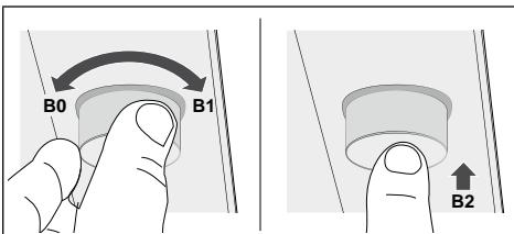
При повороте ручки по часовой стрелке скорость повышается в следующей последовательности: ВЫКЛ – 1-я – 2-я – 3-я – ИНТЕНСИВНАЯ (**B1**).
