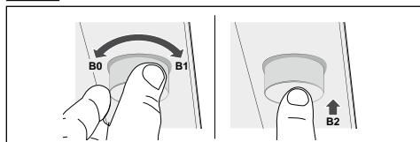
Z vrtenjem gumba v desno se poveča hitrost, in sicer: IZKLOP -1 -2 -3 - INTENZIVNA HITROST (**B1**). S spremembou hitrosti gumb zasveti močneje.
