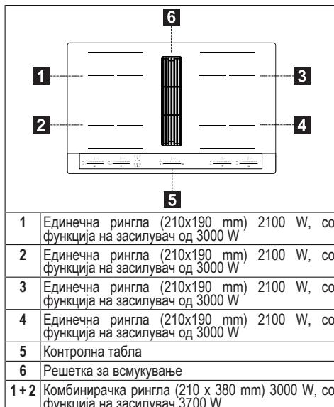
**3+4** Комбинирана рингла (210 x 380 mm) 3000 W, со функција на засилувач 3700 W.
