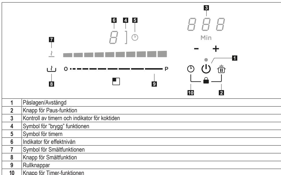
Kokzonerna kan aktiveras genom att trycka in den relativta siffran **8**. Siffran belyses mera intensivt för att bekräfta proceduren.
