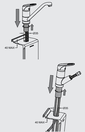
Abb.4 Den Befestigungssatz in der angegebenen Reihenfolge montieren. Bei einer Arbeitsplattenstärke von 3-4 cm Dicke muss keine Verstärkungsplatte verwendet werden. Bei Montage der Armatur auf der Edelstahlspüle muss die Verstärkungsplatte montiert werden.
