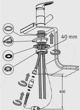
**Abb.5** Bei Armaturen mit Schlauchbrause muss der Schlauch mit dem Brausekopf verschraubt werden. Achten Sie darauf, dass die beigefügte Dichtung montiert wird. Die Flexschläuche an das Wasserleitungsnetz anschließen und den Brauseschlauch mit der Armatur verschrauben. Auf eine korrekte Schlauchführung achten.
