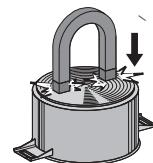
**Merk:** Bruk kun kokekar som har en helt flat bunn go som er egnet til bruk for induksjonskoking. Bruk av kokekar med bunn som ikke er helt flat kan svekke varmesystemets effektivitet og forhindre at kokekar påvises av kokesonen.
