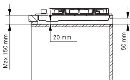
**ملاحظة مهمة:** تُعد هذه الأجهزة من النوع "7" الذي يتميز بدرجة كبيرة من الحماية ضد أخطار الحرائق. الحد الأدنى للمسافة بين حافة الجهاز هي 150 مم من جانب الحدار و 50 مم من الخلف و 700 مم من أي كابينة فوقه. ومن الأفضل دمج الجهاز في طاولة سُمكها 40 مم. في حالة اختلاف الأبعاد، يجب أن يقوم فني بإدارة التعديلات النهائية.
