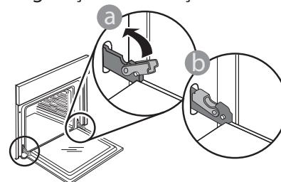
Aplicați o presiune ușoară pentru a verifica dacă dispozitivele de oprire se află în poziția corectă.
