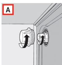
Los hornos de Franke están equipados con una lámpara circular situada en la parte superior izquierda al fondo del compartimento. Proceda del siguiente modo para sustituir la
