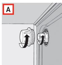
Les fours Franke sont équipés d'une ampoule circulaire placée à l'arrière du compartiment dans la partie supérieure gauche. Pour remplacer l'ampoule du four, procéder
