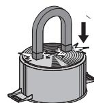
**Remarque :** utilisez exclusivement des récipients avec un fond parfaitement plat et adapté aux plaques de cuisson à induction. Utiliser des récipients avec un fond irrégulier peut menacer l'efficacité du système de chauffage et empêcher la détection du récipient sur la zone de cuisson.
