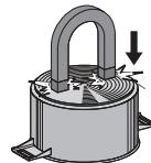
**Nota:** use solamente utensilios de cocina con un fondo totalmente plano y adecuados para cocinas de inducción. Utilizar utensilios de cocina con una base irregular podría poner en peligro la eficiencia del sistema de calentamiento e impediría que la zona de cocción detectase el utensilio.
