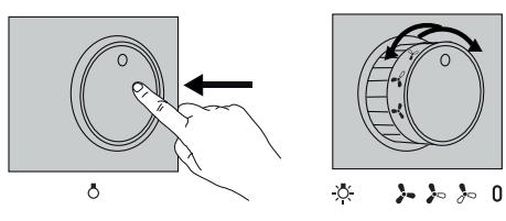
**Oświetlenie** - włącza się przez naciśnięcie pokrętła i zwolnenie go w taki sposób, aby wyszło na zewnątrz.
