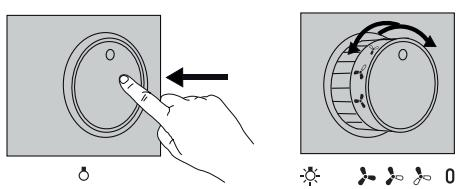
**Освещение** - Для включения освещения нажмите на ручку и отпустите, чтобы она поднялась.
