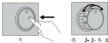
**Lumini** – Pentru a aprinde luminile, apăsați butonul rotativ și eliberați-l astfel încât acesta să iasă din locașul său.
