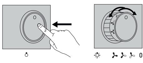
**Luzes** - Para acender as luzes, carregue no botão e liberte-o, de modo a ficar saliente. Para apagar as luzes, empurre de novo o botão, para dentro, repondo-o na posição de interruptor desligado.
